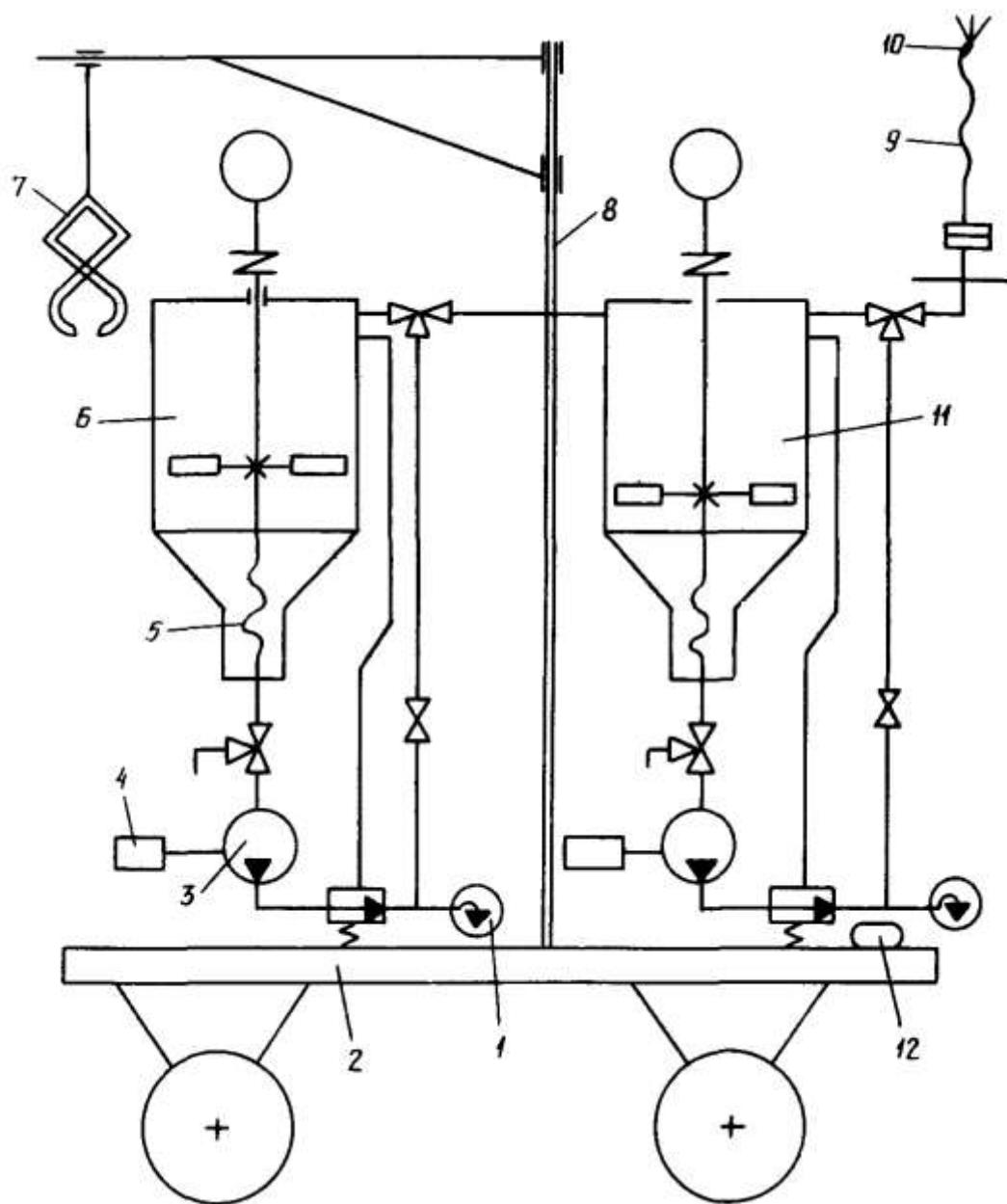
1 - манометр; 2 - пневмоколесное шасси; 3 - насос НШ; 4 - электродвигатель; 5 - шнек; 6 - емкость № 1; 7 - грузозахватное устройство; 8 - поворотная кранбалка; 9 - напорный рукав; 10 - форсунка; 11-емкость № 2; 12 - компрессор СО-45А
