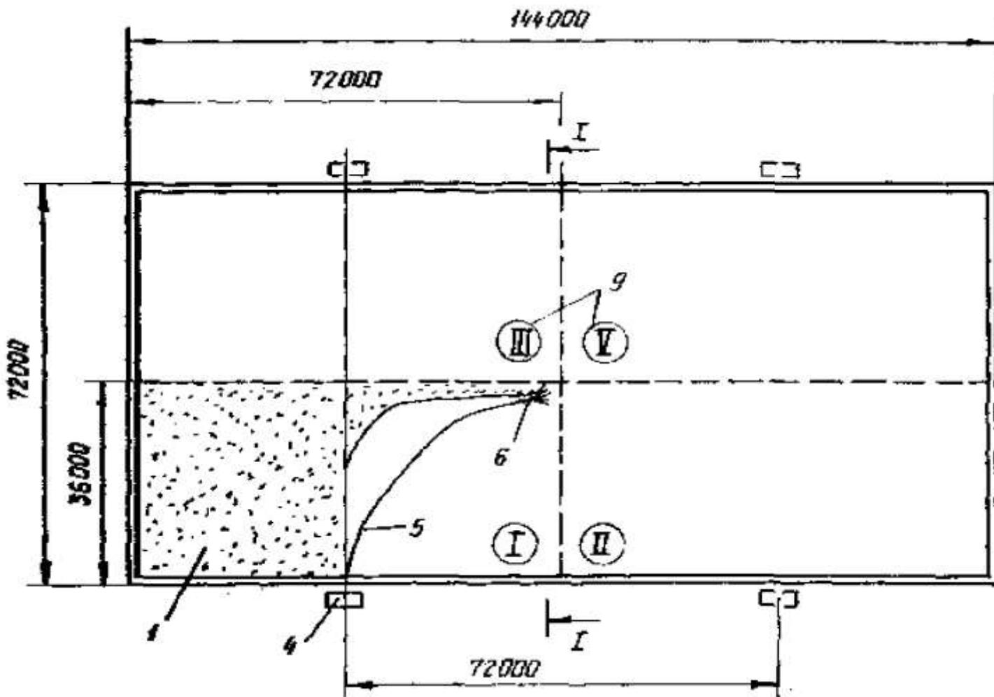
Рис. 1. Схема устройства гидроизоляционного ковра
