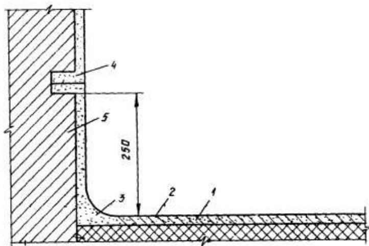
Рис. 2. Узел примыкания к парапетной стене
